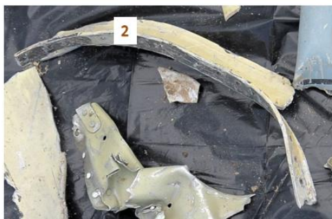
Rys. 6. Podłużnica nr 2 wyrwana i zgięta do dołu a nie wzdłuż przecięcia skrzydła, oraz miejsce jej wyrwania.
