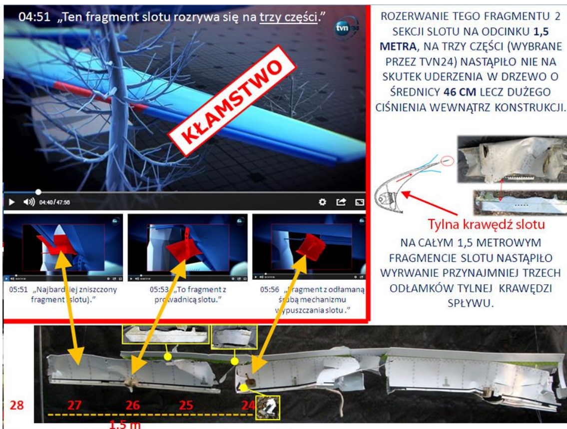
Rys. 2. . Wyrwanie, a nie zgniecenie odłamków z tylnej krawędzi slotu świadczy o ogromnym wewnętrznym ciśnieniu, które go rozerwało. Rysunek przedstawia lokalizację pokazanych przez TVN24 trzech z pięciu rozerwanych fragmentów drugiej sekcji slotu na odtworzonym przez Podkomisję modelu zniszczonego skrzydła.
