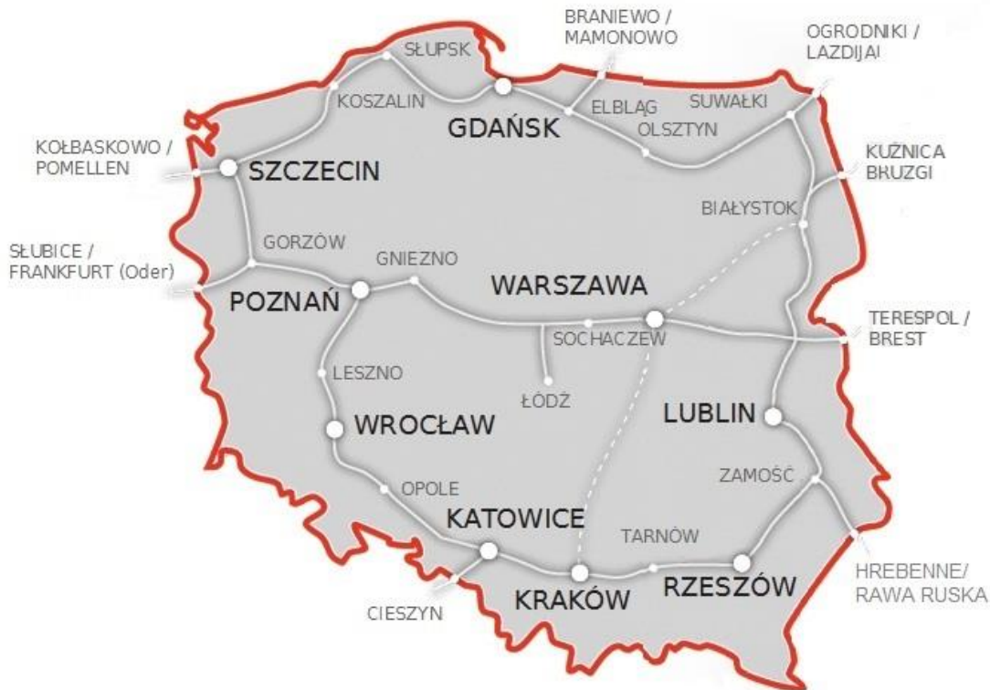
Linie białe ciągłe - sieć docelowa, w tym już wybudowana oraz w trakcie realizacji w ramach III etapu inwestycji Linie białe przerywane – relacje dzierżawione Rys. 2. Orientacyjny przebieg Ogólnopolskiej Sieci Światłowodowej HAWE
