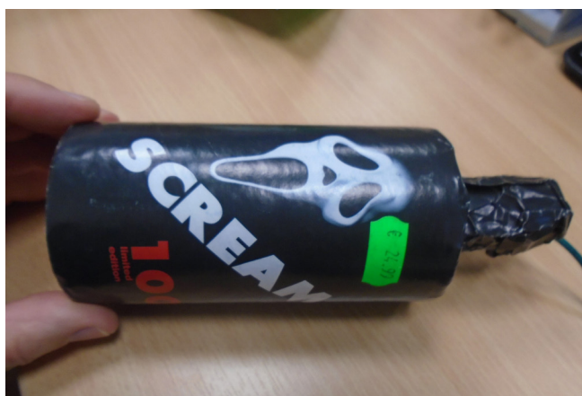
Petardy, w których inspektorzy stwierdzili brak zabezpieczenia systemu inicjującego oraz brak lub nieprawidłowe oznaczenia (2018 r.)
