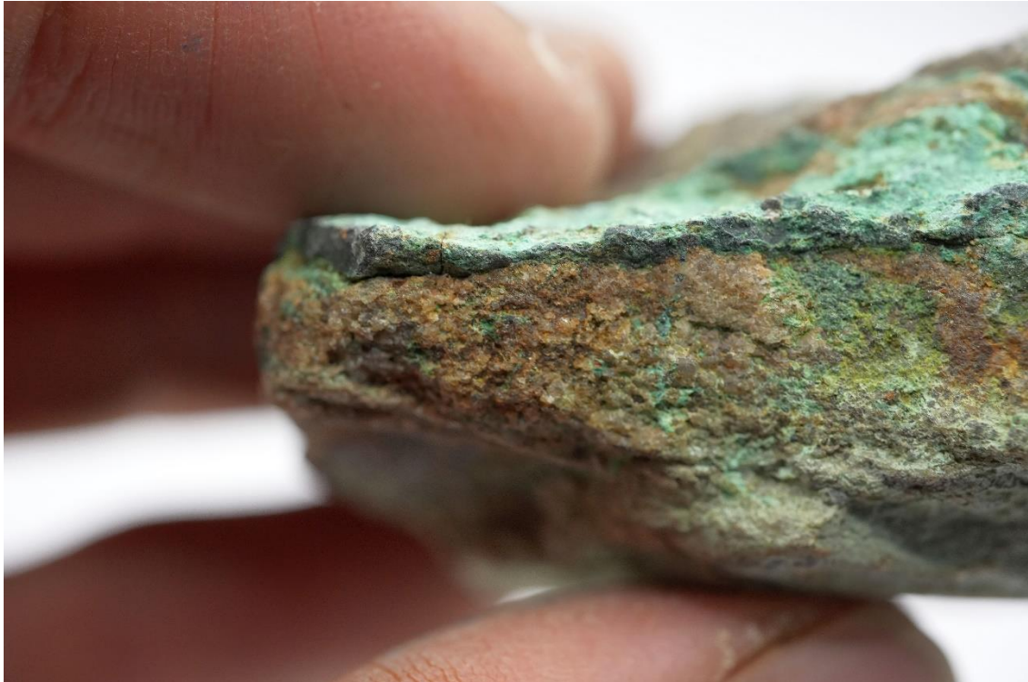
Rys. 8: Żyła chalkozynu osadzona w piaskowcu z próbki A1197d.
